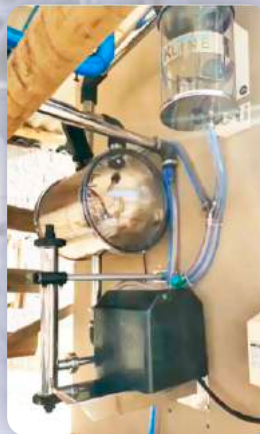
EQUIP. DE ORD. UNID. FINAL 40 LTS GARRAÇÃO HORIZONTAL Cód. 14106
